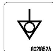
Dank der potenzialausgleichenden Massenöse können alle Vorrichtungen desselben Orts elektrisch verbunden werden, um sicherzustellen, dass keine elektrischen Potentialdifferenzen zwischen Geräten bestehen, die gefährlich sein könnten.
